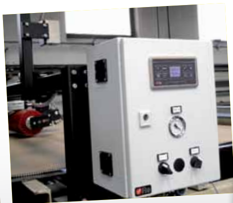
Равнение ReCorr на гофроагрегате ReCorr webguide on corrugating plant
