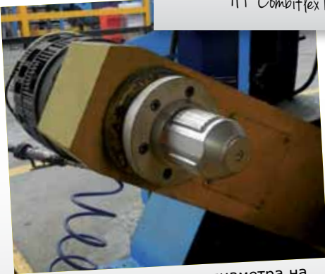
Зажим Rotogrip одного диаметра на размотке Rotogrip monodiametral chuck on unwinder
