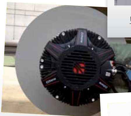
Тормоза EXtreme на раскате EXtreme brakes on unwinder
