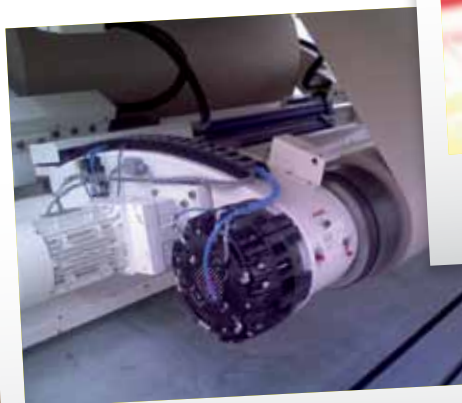
Тормоза Combiflex HP на раскате HP Combiflex brakes on unwinder
