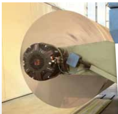
Тормоза EXtreme на раскате EXtreme brakes on unwinder
